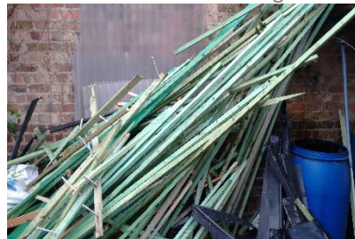
Opnieuw te gebruiken panlatten (foto's: NAD & WTCB)
