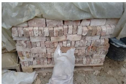
Uitgebroken bakstenen, op pallets bewaard
