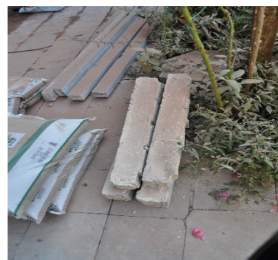
Linteau en béton
